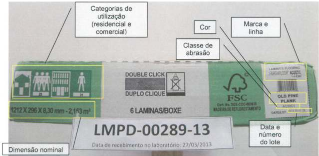
Foto 2 – Informações impressas na embalagem da amostra recebida: códigos do sistema de classificação para categorias de utilização, dimensão nominal, marca, linha, cor ou padrão, classe de abrasão, data e número do lote.
