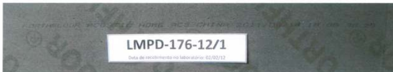
Foto 3 – Informações impressas no verso de uma placa retirada da amostra: marca comercial, linha, classe de abrasão, país de origem, data (ano/mês/dia), hora de fabricação e número de lote.
