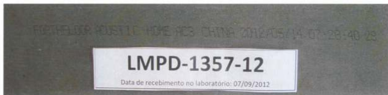
Foto 3 – Informações impressas no verso de uma placa retirada da amostra: marca comercial, linha, classe de abrasão, país de origem, data (ano/mês/dia), hora de fabricação e número de lote.
