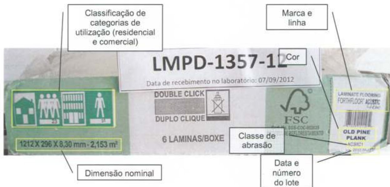
Foto 2 – Informações impressas na embalagem da amostra recebida: códigos do sistema de classificação para categorias de utilização, dimensão nominal, marca, linha, cor ou padrão, classe de abrasão, data e número do lote.
