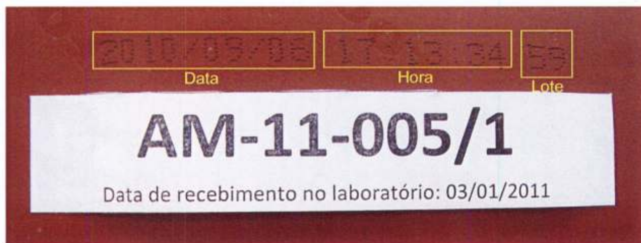
Foto 4 – Informações impressas no verso de uma placa retirada da amostra: data (ano/mês/dia), hora e número de lote.
